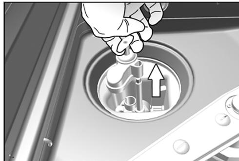
3. Reinigen Sie das Rückschlagventil unter fließendem Wasser. Verwenden Sie kein Spülmittel!
