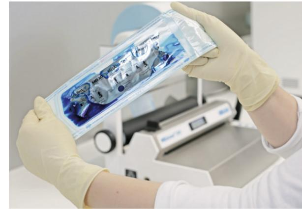
Der Tintentest **MELAG Ink Test** ist ein zuverlässiges Prüfmittel zur **wöchentlichen** Kontrolle der Siegelnähte auf Dichtigkeit gemäß DIN EN ISO 11607-1 und ASTM F1929-12.
