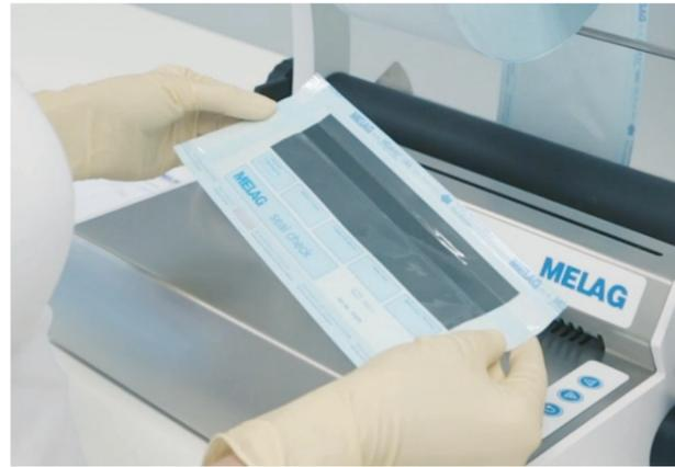
Der **täglich** durchzuführende **MELAG Seal Check** verifiziert die Qualität der Siegelnaht nach DIN EN ISO 11607-2.
